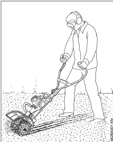
Das MultiWerkzeug Rasenlüfter RL-MM dient zum Belüften von Rasenflächen (vertikutieren).
